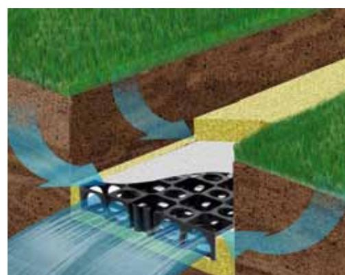
Atlantisove drenažne cijevi su prethodno umotane u visokokvalitetni geotekstil, spremne za ugradnju. Naše se cijevi mogu postaviti polegnute ili bočno, ovisno o primjeni.
